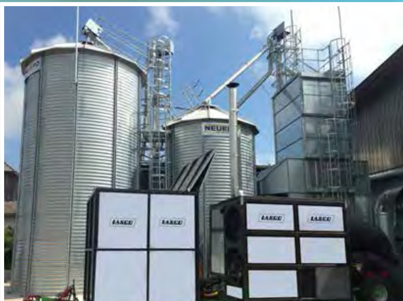
Utánfutóra szerelt, meleg levegős LA 750, külön kialakított apríték tárolóval.
